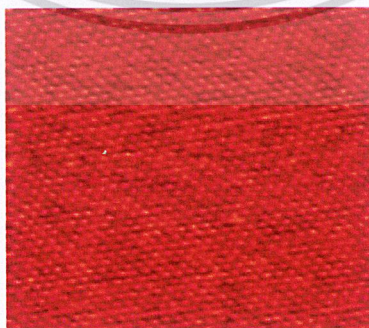
รูปที่ 2.13 แสดงภาพของพื้นผิวของกราฟไฟต์ขนาด 8 \times 8 ตร.นาโนเมตรจากเครื่อง STM ที่ให้ความละเอียดในระดับอะตอม
