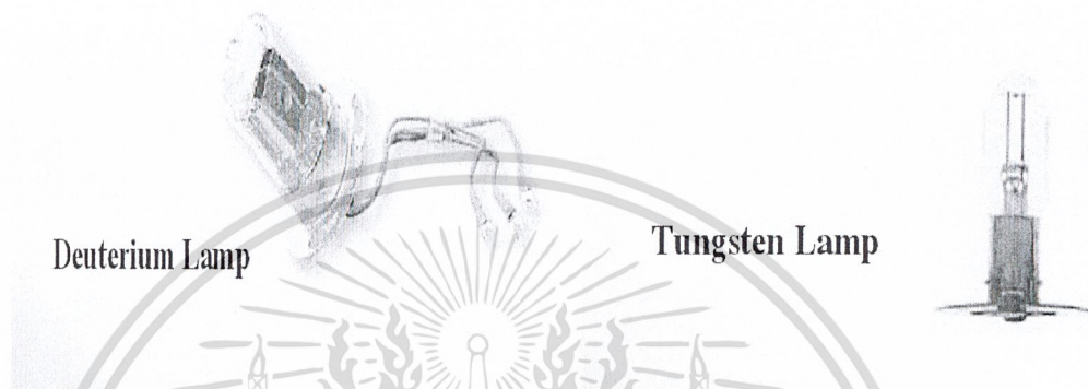
รูปที่ 2.8 แผนภาพแสดงหลอดรังสีที่ใช้เป็นแหล่งกำเนิดรังสีในสเปกโทรโฟโตมิเตอร์
