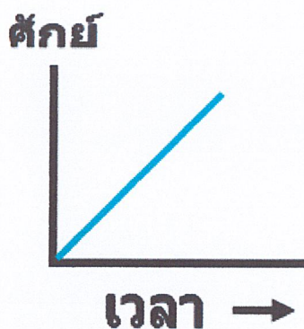
รูปที่ 2.11 กราฟแสดงความสัมพันธ์ระหว่างศักย์ไฟฟ้ากับเวลาแบบเทคนิคโพลาโรกราฟี
