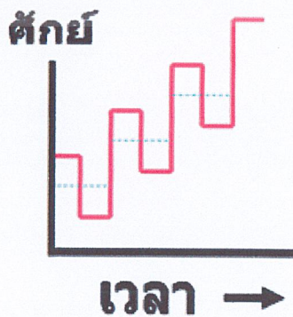
รูปที่ 2.21 กราฟแสดงความสัมพันธ์ระหว่างศักย์ไฟฟ้ากับเวลาของพัลส์โวลแทจเมทรีแบบสแควร์ - เวฟ
