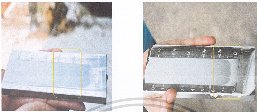
ภาพที่ 4.7 แสดงการทดสอบความละเอียดของสีทาอาคารที่ผลิตได้ (ภาพซ้าย) และ สีทาอาคาร ยี่ห้อ Beauty (ภาพขวา)
