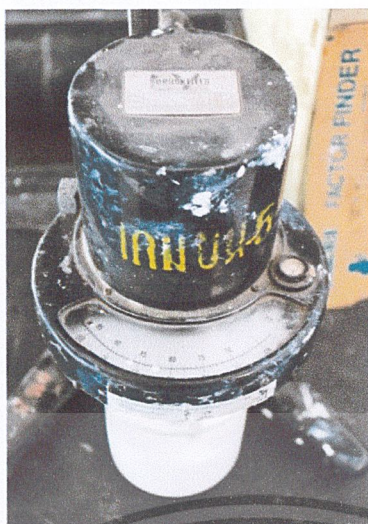
ภาพที่ 4.2 แสดงการทดสอบความหนืดของเรซินที่สังเคราะห์ได้ โดยใช้เครื่อง Brookfield
