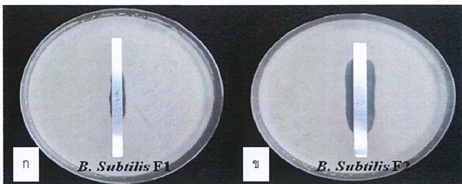
รูปที่ ๒๘ ฤทธิ์การต้านจุลินทรีย์ของสารองค์ประกอบส่วนที่ 1 (ก) และส่วนที่ 2 (ข) ต่อเชื้อบาซิลลัส สับทิลิส เอทีซีซี ๖๖๓๓ ( Bacillus subtilis ATCC 6633)
