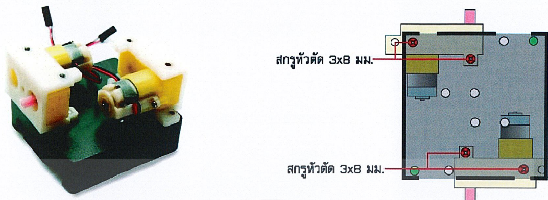
รูปที่ 3.14 ติดตั้งชุดเฟืองขับเคลื่อนเข้ากับถาดรองกระเบื้อง
