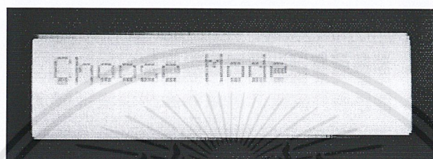
รูปที่ 4.7 ผลบอกผู้ใช้งานให้เลือกโหมดในการยืม - คืนหนังสือโดยการกดปุ่ม
