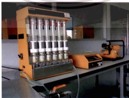
ภาพที่ 2 ก เครื่องวัดปริมาณไขมัน Soxhlet Extraction
