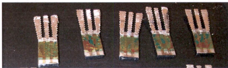
รูปที่ 3.6 อุปกรณ์ ISFET ที่จะนำมาใช้เป็นตัวตรวจจับสัญญาณของไหล
