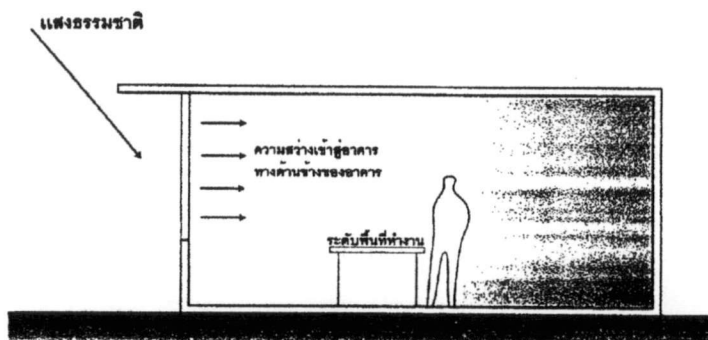
รูปที่ 2.47 แสดงการเข้าของแสงธรรมชาติเข้าทางด้านข้างอาคาร
