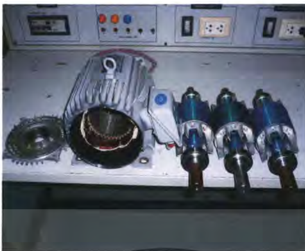
รูปที่ 4.7 เครื่องกำเนิดไฟฟ้าเหนี่ยวนำสามเฟสแบบกระตุ้นภายในตัวเองที่มีการทำสกีวอิงบน โรเตอร์มุม 0^\circ , 5^\circ และ 10^\circ
