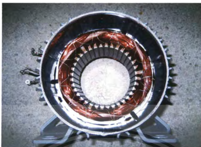
รูปที่ 5.17 (ก) สเตเตอร์ของเครื่องกำเนิดไฟฟ้าเหนี่ยวนำที่ออกแบบ
