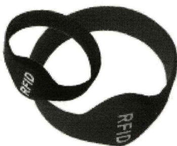
รูปที่ 2.6 แท็กแบบเซมิแอ็กทีฟ (Semi-Active Tag) ในรูปแบบ Wrist Band [5]
