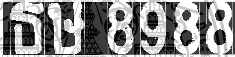
รูปที่ 3.12 ขอบเขตด้านซ้ายสุดและขอบเขตด้านขวาสุด (แสดงด้วยเส้นทึบสีขาว) ของตัวเลขและตัวพยัญชนะของกลุ่มพิกเซลสีขาวที่มีหมายเลขที่ต่างกัน
