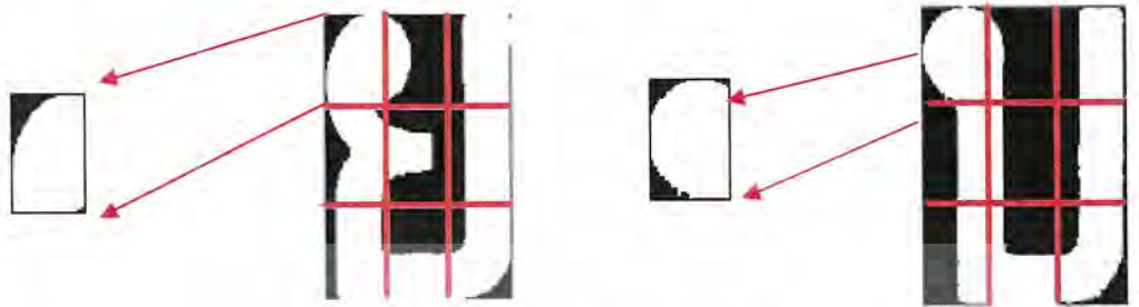
รูปที่ 4.13 ภาพที่ได้หลังจากการดึงส่วนที่มีกลุ่มพิกเซลสีขาวที่มากที่สุดออกมา
