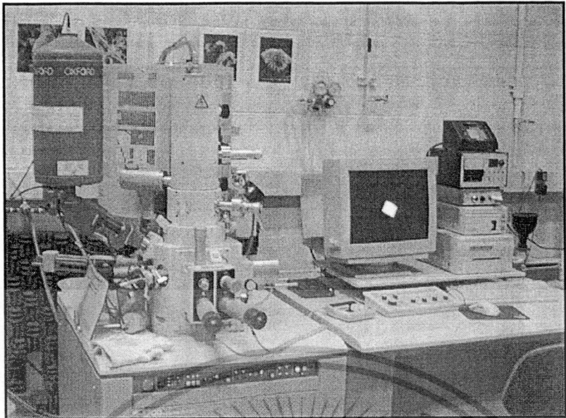
รูปที่ 3.9 กล้องจุลทรรศน์อิเล็กตรอนแบบเปล่งกราดชนิด Field Emission (FE-SEM) , Hitachi รุ่น S4700
