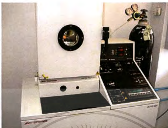
รูปที่ 3.15 ระบบระเหยสารด้วยลำอิเล็กตรอนในสุญญากาศ
