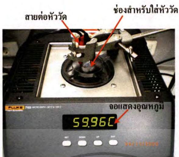
รูปที่ 4.12 เครื่องทำอุณหภูมิมาตรฐานแบบอ่างของเหลว (Fluke 7103 Micro Bath)
