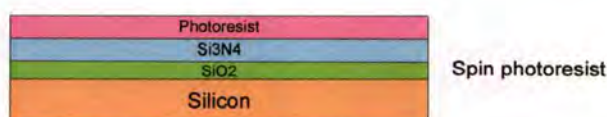
รูปที่ 3.9 แสดงโครงสร้างของการเคลือบน้ำยาไวแสงด้วยเครื่องหมุนเคลือบ
