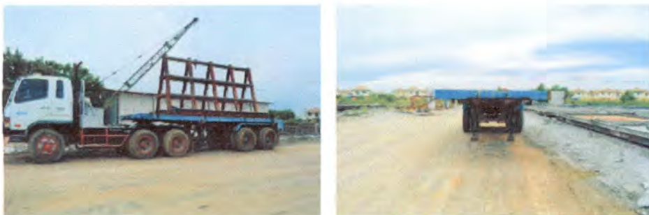
รูปที่ 4.72 แสดงเครื่องมือในการขนส่งชิ้นส่วนสำเร็จรูป
