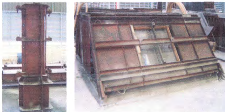
รูปที่ 4.141 แสดงแบบหล่อที่ทำจากเหล็กใช้สำหรับหล่อชิ้นส่วนพิเศษ
