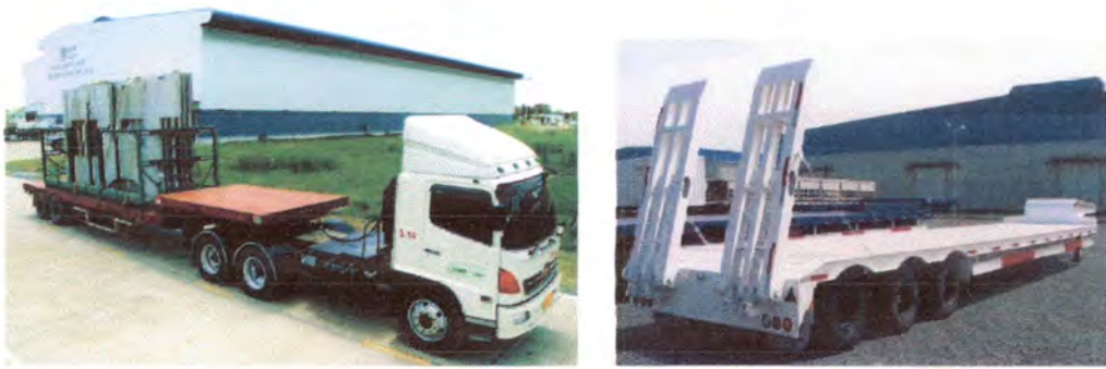
รูปที่ 4.151 แสดงรถเทรลเลอร์ที่ใช้ในการบรรทุกแผ่นไปยังหน้างานการก่อสร้าง (ที่มา:เอกสารประกอบการเข้าเยี่ยมชมโรงงานการผลิต วันที่ 17 ตุลาคม 2553)
