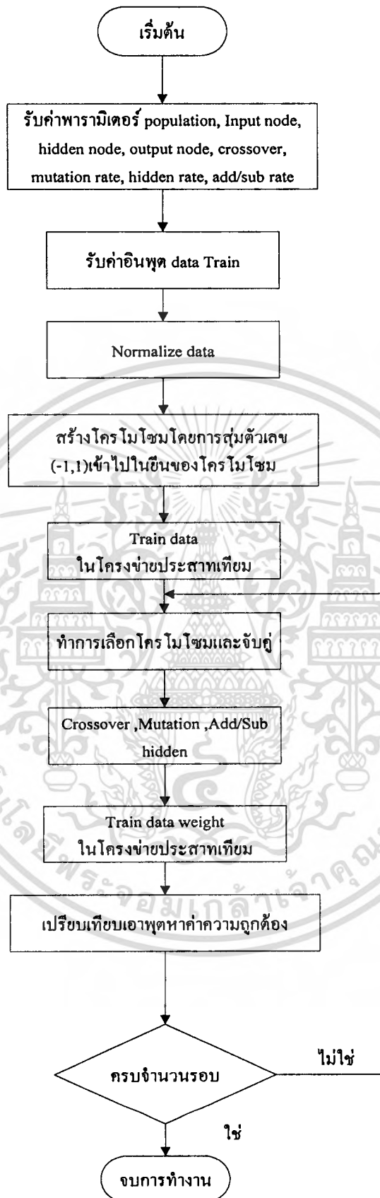
รูปที่ 3.7 แสดงการทำงานของโปรแกรมส่วนฝึกหัดโครงข่าย GA
