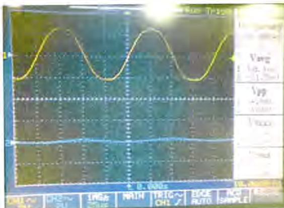
รูปที่ 4.3 สัญญาณอินพุตและเอาต์พุตของวงจรกรองความถี่ต่ำผ่าน 500 เฮิรตซ์
