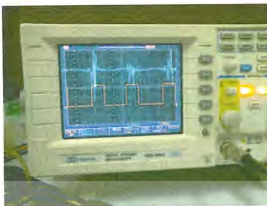
รูปที่ 4.10 วัดหลังจากที่สัญญาณผ่านวงจรโมโนสเตเบิล
