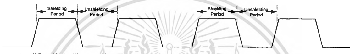
รูปที่ 2.8 สัญญาณเอาต์พุตของตัวตรวจจับตำแหน่งการหมุนของ โรเตอร์ 8 ขั้วแม่เหล็ก
