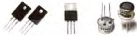
รูปที่ 2.42 ทรานซิสเตอร์ชนิด เอ็นพีเอ็น (NPN)
