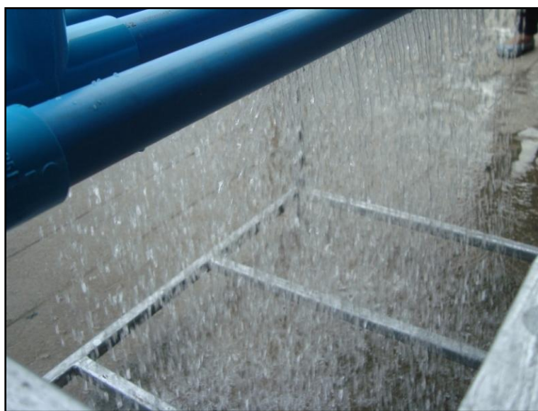
รูปที่ 2.22 การทดลองเครื่องลดอุณหภูมิเบื้องต้นด้วยน้ำขณะสเปรย์น้ำ
