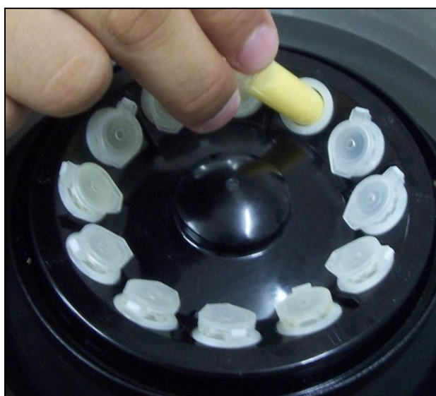
รูปที่ 2.30 การแยกสารในเมล็ดข้าวโพดหวานที่ต่างกันด้วยเครื่องหมุนเหวี่ยง
