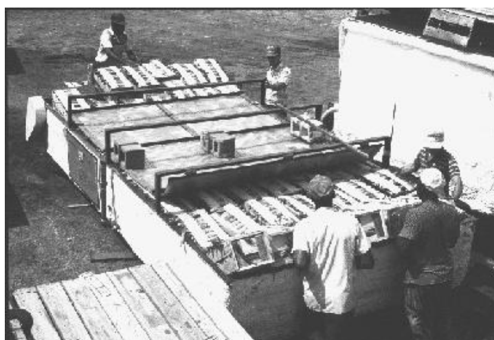
รูปที่ 2.12 เครื่องลดอุณหภูมิเบื้องต้นด้วยน้ำแบบจุ่ม ที่มา : (Boyette, Estes and Rubin. 2010)
