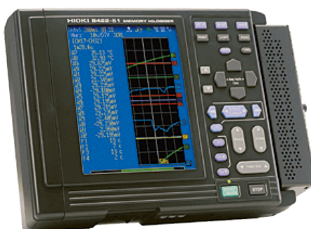
รูปที่ 2.27 เครื่องบันทึกอุณหภูมิ ที่มา : (HIOKI. 2000-2010)
