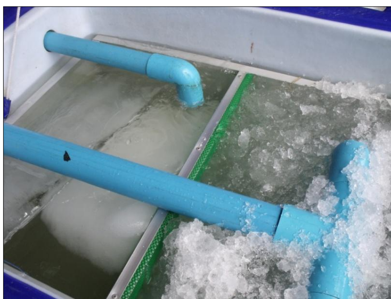
รูปที่ 2.23 ถังเก็บน้ำเย็นของการลดอุณหภูมิเบื้องต้นด้วยน้ำ (ประมาณ 2 องศาเซลเซียส)
