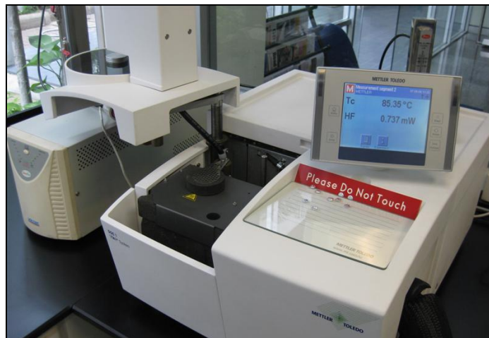
รูปที่ 3.13 Differential Scanning Calorimeter (DSC) ที่มา : เมทเลอร์-โทเลโด (2553)
