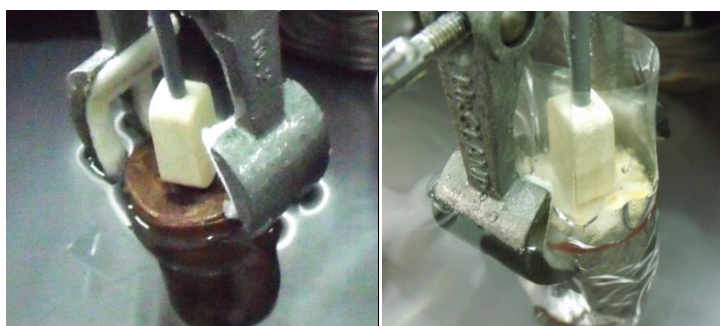
รูปที่ 3.12 การวัดค่าการนำความร้อนของตัวอย่างในอ่างควบคุมอุณหภูมิ
