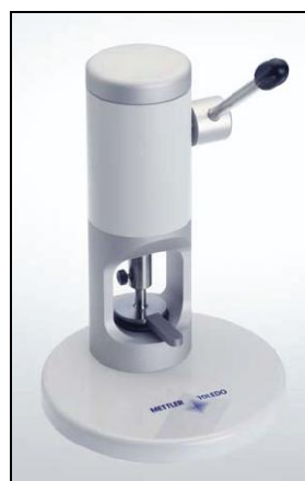
รูปที่ 3.15 เครื่องปิดผนึก crucible แบบกด ที่มา : (เมทเลอร์-โทเลโด. 2553)
