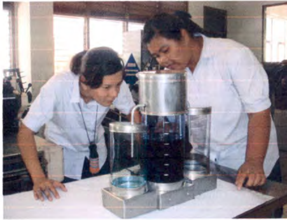
ภาพที่ จ4 การแยกหมักพืชมัทและน้ำมันก๊าดด้วยเครื่องแยก
