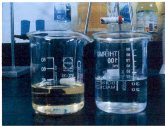
ภาพที่ 4.6 น้ำมันก๊าดที่ได้หลังจากทำการแยกด้วยเครื่องแยกหมักพิมพ์จากน้ำมันก๊าด
