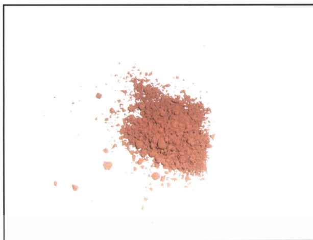
รูปที่ 4.1 ลักษณะของแคลเซียมคอปเปอร์ไททานेट (CCTO) ที่ได้จากการสังเคราะห์ด้วยวิธีปฏิกิริยาสถานะของแข็ง (solid-state reaction)
