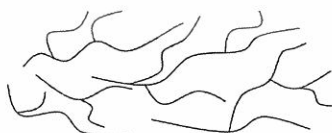
รูปที่ 2.1 โครงสร้างสายโซ่พอลิเอทิลีนชนิดความหนาแน่นต่ำ [13]
