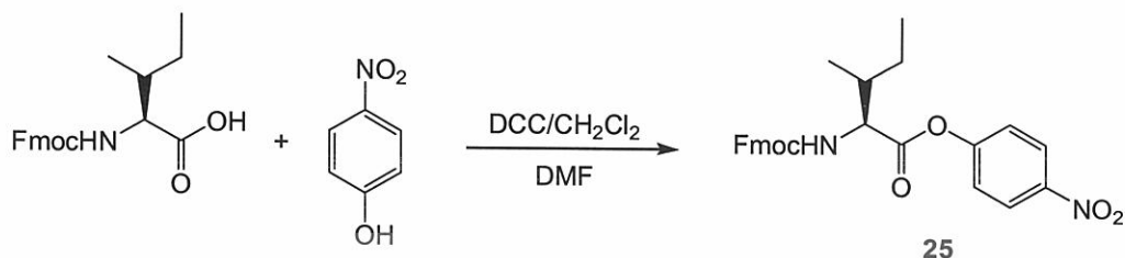
รูปที่ 4.10 แสดงการสังเคราะห์การใส่หมู่กระตุ้นหมู่คาร์บอกซิลิกของ Fmoc-Isoleucine
