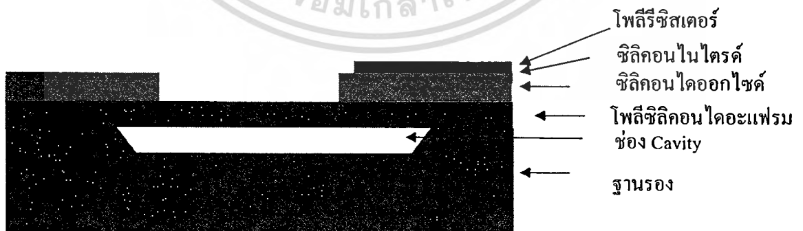
รูปที่ 4.1 ภาพตัดขวางของอุปกรณ์ตรวจจับความดันชนิดเปียโซรีซิสทีฟที่ใช้ในงานวิจัย
