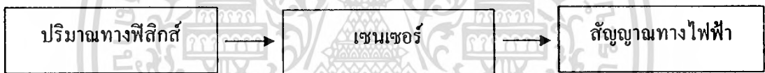
รูปที่ 2.1 หลักการทำงานของเซนเซอร์ที่เปลี่ยนปริมาณทางฟิสิกส์เป็นสัญญาณทางไฟฟ้า
