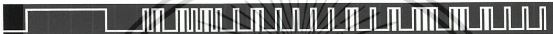
รูปที่ 4.28 สัญญาณอินฟราเรด ปุ่ม 6 จากรีโมทของ True Visions
