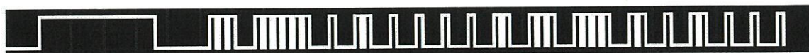
รูปที่ 4.24 สัญญาณอินฟราเรด ปุ่ม 2 จากรีโมทของ True Visions
