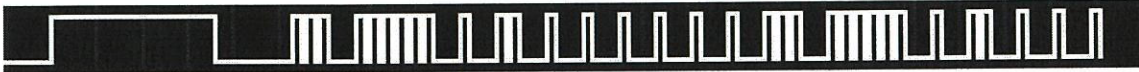
รูปที่ 4.25 สัญญาณอินฟราเรด ปุ่ม 3 จากรีโมทของ True Visions
