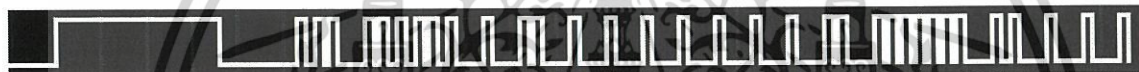
รูปที่ 4.29 สัญญาณอินฟราเรด ปุ่ม 7 จากรีโมทของ True Visions
