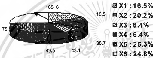
รูปที่ 2.7 แสดงเทคนิควิธีการสุ่มโครโมโซมต้นแบบด้วยการจำลองการหมุนวงล้อแบบถ่วงน้ำหนัก (Roulette wheel selection)
