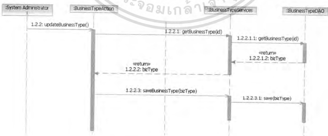
รูปที่ 3.6 ซีเควนซ์ไดอะแกรมของการแก้ไขข้อมูลประเภทธุรกิจ
