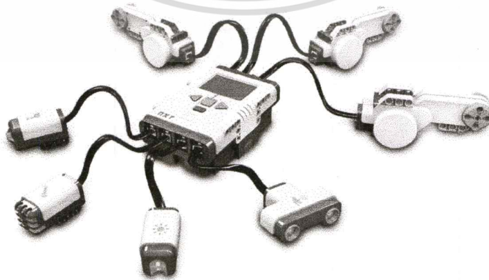
รูปที่ 2.1 ชุดทดลองระบบฝังตัวเลโก้มายสตรอมรุ่นเอนเอ็กซ์ที
