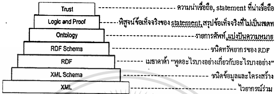
รูปที่ 2.3 ลำดับชั้นเลเยอร์เค้กของเว็บเชิงความหมาย
