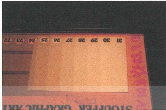
รูป 76 อัด step 31 - 25 เพื่อนำมาเปรียบเทียบกับ D-max ที่ทดสอบไว้
