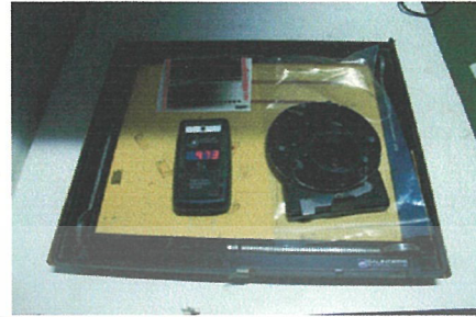
ภาพที่71 เตรียมอุปกรณ์สำหรับทดสอบ D-max ,D-min ภาพที่72 เตรียมอุปกรณ์สำหรับวัด density
