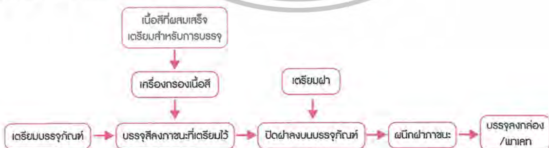
ภาพที่ 73 แสดงขั้นตอนกระบวนการบรรจุสีลงบรรจุภัณฑ์ (ภากร ชีรภัทรอนันต์.2552)
