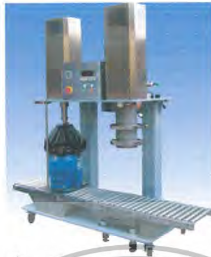
ภาพที่ 74 แสดงภาพเครื่องบรรจุสี ( http://www.pacificsolution.co.th/images/f1002.jpg )
