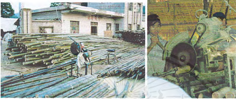
ภาพที่ 2-33 แสดงกระบวนการผลิตไม้ไผ่อัดประสาน
