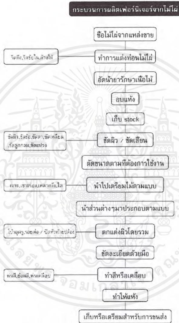
ตารางที่ 2-4 แสดงแผนภูมิการผลิตเฟอร์นิเจอร์ไม้ไผ่
