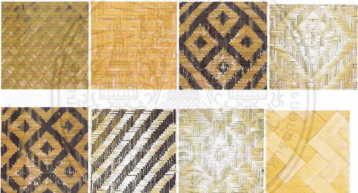
ภาพที่ 2-32 แสดงตัวอย่างฟากไม้ไผ่อัดแผ่น
