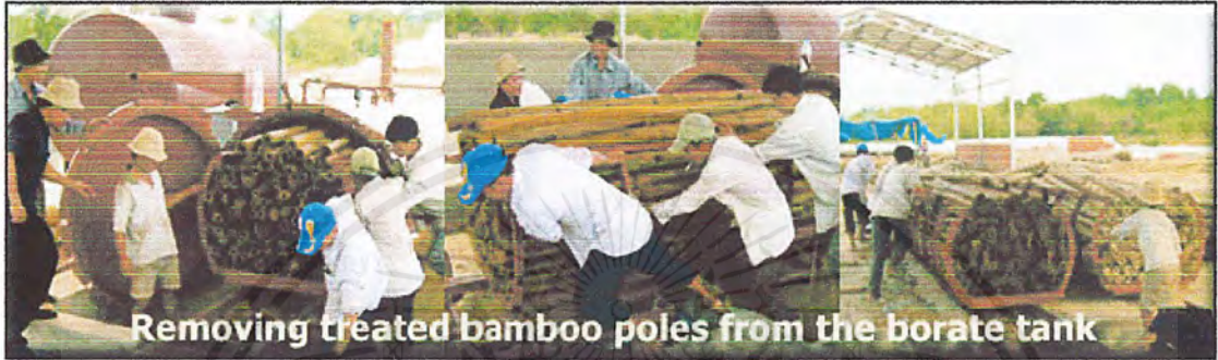
ภาพที่ 2-14 แสดงการนำไม้ไผ่เข้าเครื่องอัดน้ำยาเพื่อรักษาเนื้อไม้
