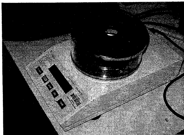
รูปที่ 3.10 เครื่องชั่งน้ำหนัก ความละเอียด 0.01 g
