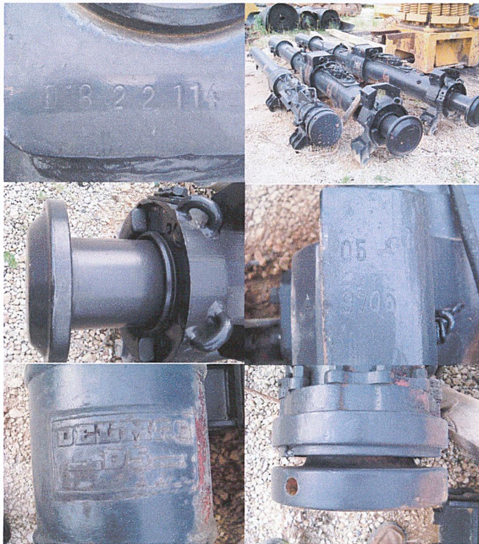
รูปที่ 4.6 ข แสดงลักษณะของลูกตุ้มแบบ Diesel hammer
