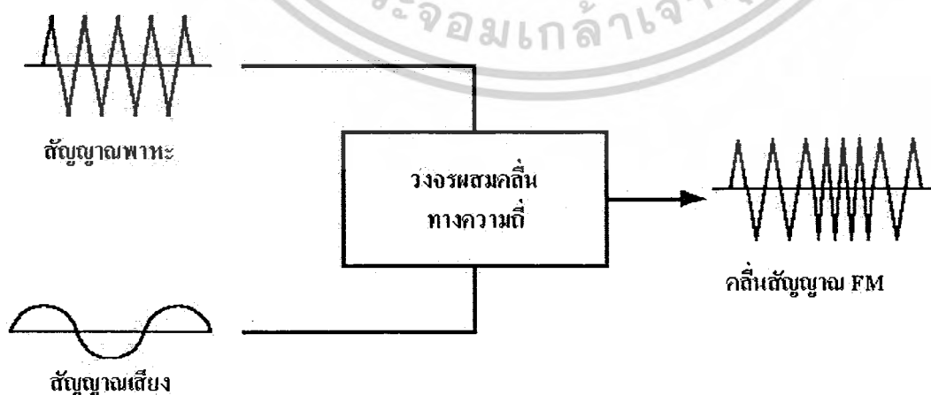
รูป 2.27 วงจรที่ทำให้เกิดการผสมคลื่นแบบเอฟเอ็ม
