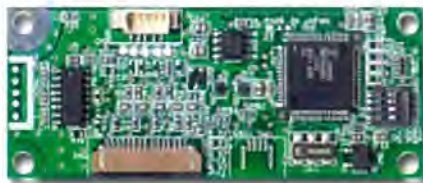
รูปที่ 3.4 แผงวงจรควบคุมการทำงานของแผ่นหน้าจอบแบบสัมผัส
