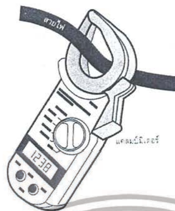
รูปที่ 2.3 การวัดกระแสโดยใช้แคลมป์มิเตอร์
