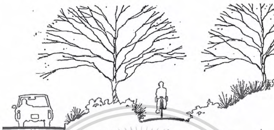
เส้นทางจักรยานที่แยกเฉพาะจากเส้นทางจราจรอื่น
