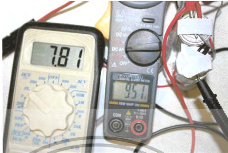
รูปที่ 4.8 แสดงกระแสและแรงดันขณะชาร์จผ่านที่กระแส 10A
