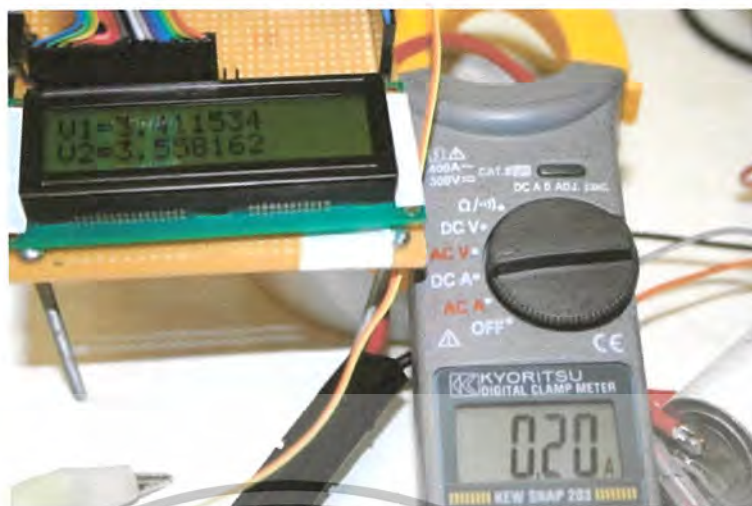
รูปที่ 4.6 กระแสชาร์จและแรงดันก่อนแต่ก่อนขณะเริ่มชาร์จถ่าน
