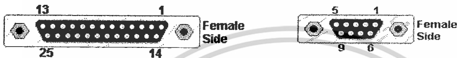
รูปที่ 2.15 ลักษณะของหัวต่อแบบ DB25 และ DB9 (ที่มาจาก [5])
