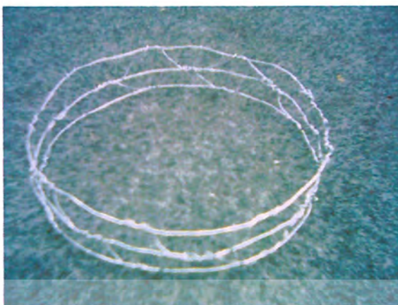
รูปที่ 4.6 โครงทวดเสริมความแข็งแรงสำหรับฉนวนซีเมนต์
