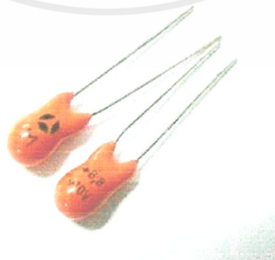
รูปที่ 2.15 โครงสร้างและลักษณะของตัวเก็บประจุแบบแทนทาลัม
