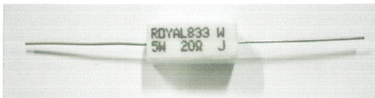
รูปที่ 3.5 ตัวต้านทานหน่วงภาคแรงสูงสำหรับวัตต์แรงดันอิมพัลส์
