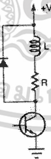
ภาพที่ 2.35 วงจรที่ใช้ไดโอดมาจำกัด (Diode suppression)
