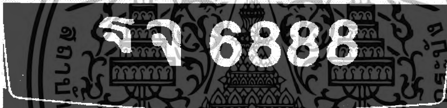
ภาพที่ 3.13 ภาพที่ได้จากการกำจัดส่วนที่เป็นชื่อจังหวัดออกไปจากภาพที่ 3.12
