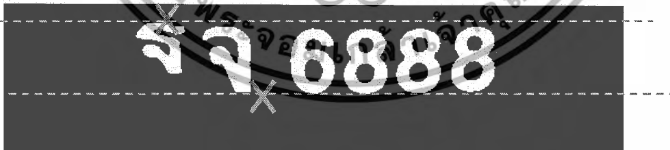
ภาพที่ 3.16 แสดงแถวที่เป็นแกนอ้างอิงในการตัดขอบบนและขอบล่าง
