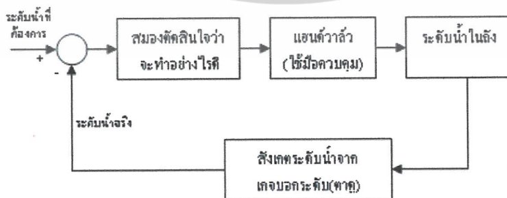
ภาพที่ 3.2 แสดงบล็อกไดอะแกรมของการควบคุมระดับน้ำในถังแบบ Manual Control
