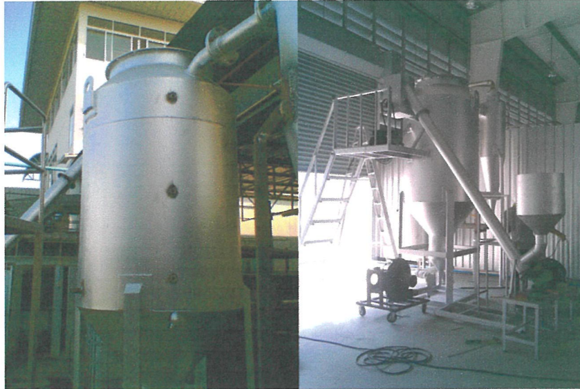
รูปที่ 4.2 ด้านซ้ายของแก๊สซิฟายเออร์แสดงช่องสำหรับเสียบเทอร์โมคัปเปิลที่ตำแหน่งต่างๆ (ซ้าย) และด้านขวาของแก๊สซิฟายเออร์แสดงการเชื่อมต่อกับระบบป้อนวัตถุดิบ (ขวา)
