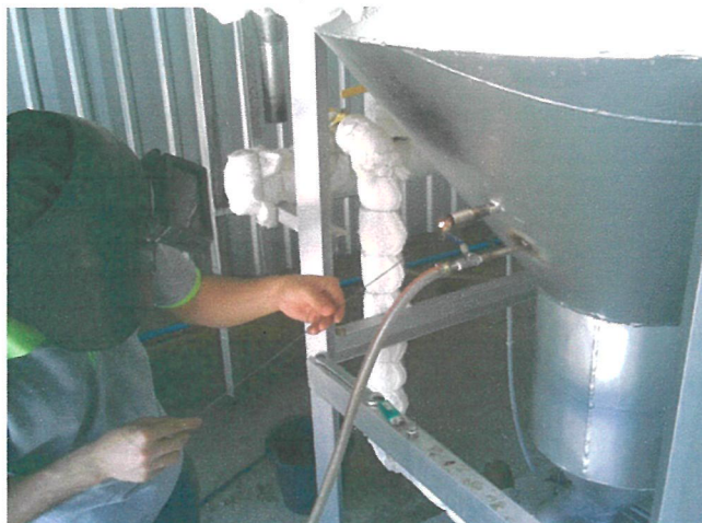
รูปที่ 3.12 การจุดเตาด้วยลวดพันผ้าชุบน้ำมันจุดไฟ
