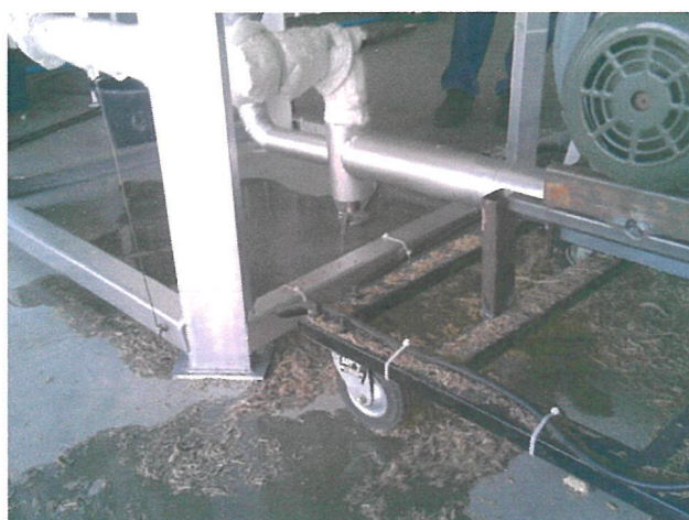
รูปที่ 5.4 น้ำที่ท่วมขังอยู่ในท่อฟลูอิดไคซ์แก๊สไหลออกมาหลังจากการคลายน็อต
