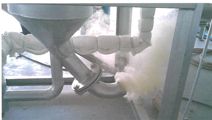
รูปที่ 5.13 ตัวอย่างปัญหาฝุ่นควันและแก๊สที่ออกมาจากระบบ
