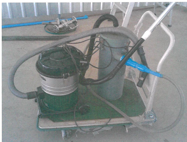
รูปที่ 3.11 เครื่องดูดฝุ่น 2 เครื่องที่ใช้ในการทำความสะอาดภายในแก๊สซิฟายเออร์
