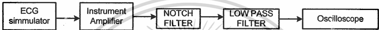
รูปที่ 3.1 แสดงบล็อกไดอะแกรมโดยวัดจาก ECG Simulator
