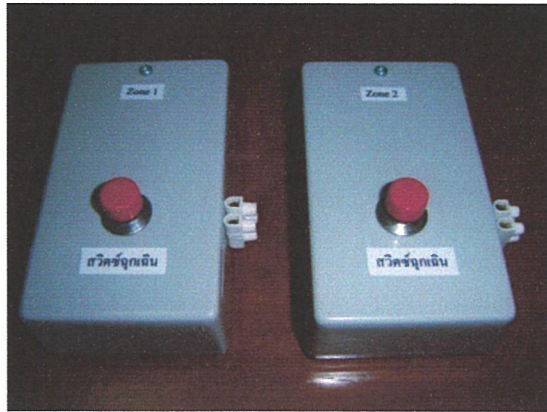
รูปที่ 4.18 การนำอุปกรณ์ลงกล่องควบคุมของวงจรภาคส่ง
