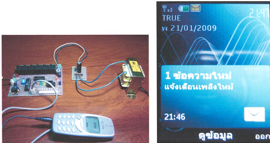
รูปที่ 5.7 แสดงการต่อวงจรพร้อมใช้งาน และข้อความที่ได้รับเมื่อมีการแจ้งเตือน
