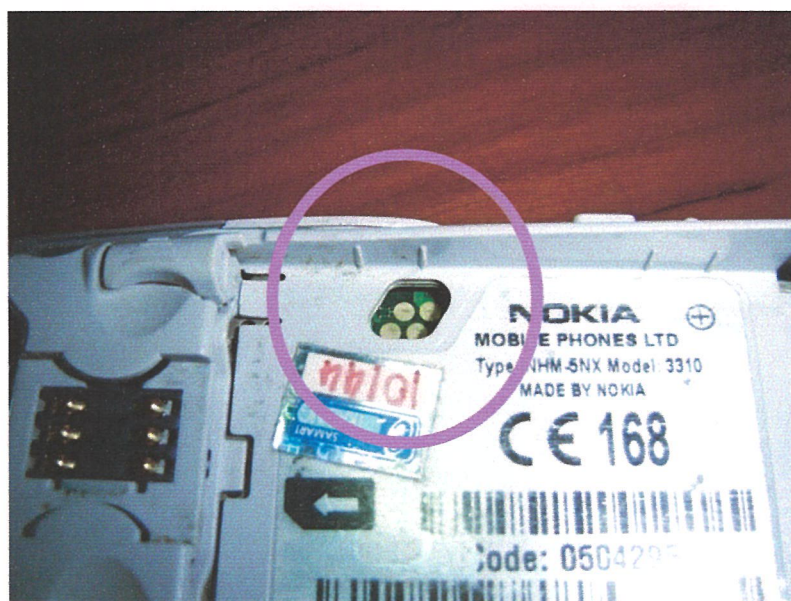
รูปที่ 4.13 แสดงพอร์ตอนุกรมสื่อสารของโทรศัพท์มือถือ
