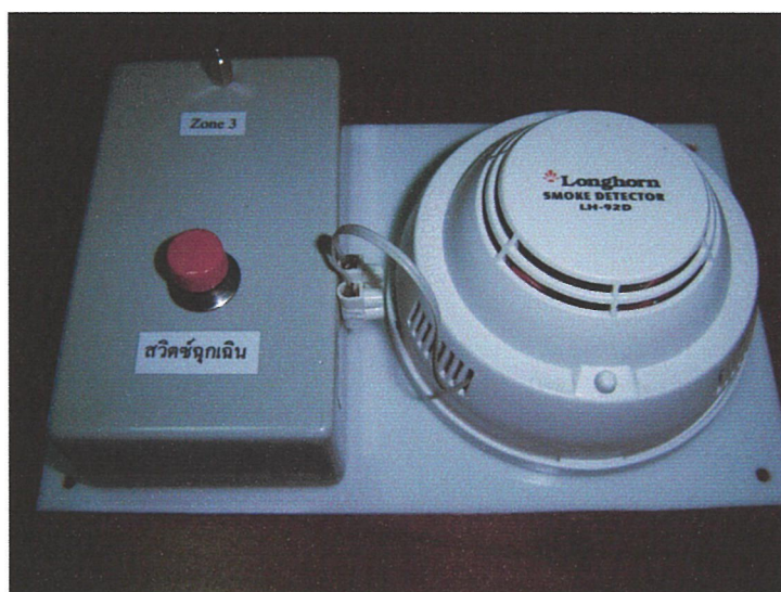
รูปที่ 5.6 วงจรภาคส่งที่ติดตั้งพร้อมใช้งาน
